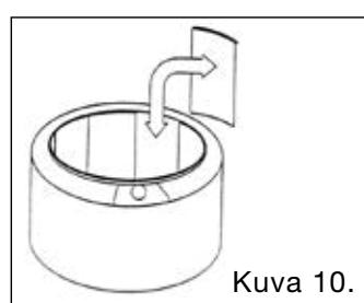
Kuva 10. Säätölevyjen asennus
