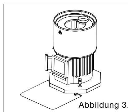
**Abbildung 3.** Falls der Saunaofen auf einen Fußboden aus entflammbarer Material installiert wird, muss die Narvi-Installationsunterlage benutzt werden. Vor der Installationsunterlage wird ein Blech befestigt, welches die Seiten der Türluke des Saunaofens um mindestens 100 mm überschreitet und sich 400 mm vor dem Saunaofen erstreckt. Die Blechseite am Saunaofen wird nach oben gebogen, damit keine glühenden Kohlen unter die Installationsunterlage geraten.
